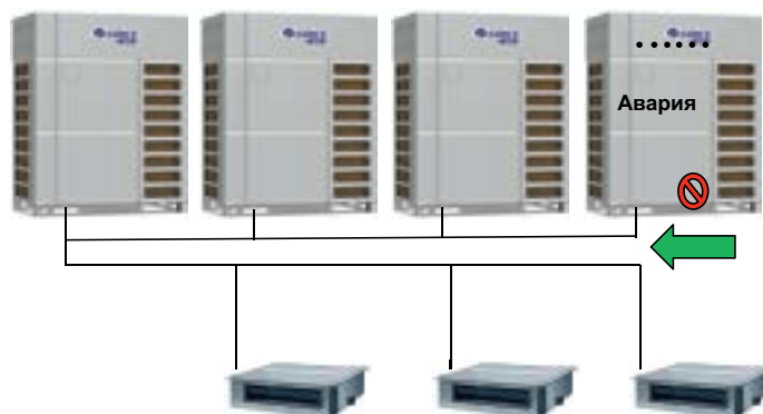
Извлечение хладагента из наружного блока
