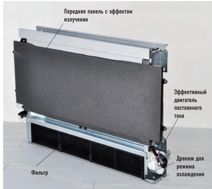
В зимнее время используется микровентилятор с очень низким энергопотреблением и минимальным уровнем шумов. С его помощью создается поток теплого воздуха вдоль внутренней стороны передней панели, благодаря чему панель эффективно прогревается. Терминал обеспечивает достаточную мощность нагрева, даже если вентилятор не работает. Благодаря этому поддерживается комфортная температура без шума и движения воздуха. В «летнем» режиме поток воздуха позволяет избежать формирования росы на передней панели.
