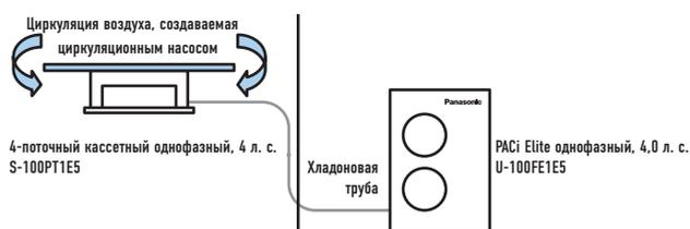
Заданная температура внутри помещения 27/19°C. Выключите конденсатор и нагреватель внутреннего блока и продолжите работу на охлаждение (циркуляционный насос ВКЛ.)
