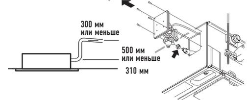
Техническое обслуживание дренажного насоса можно осуществлять с двух сторон: с левой стороны (со стороны трубопровода) и изнутри блока.
