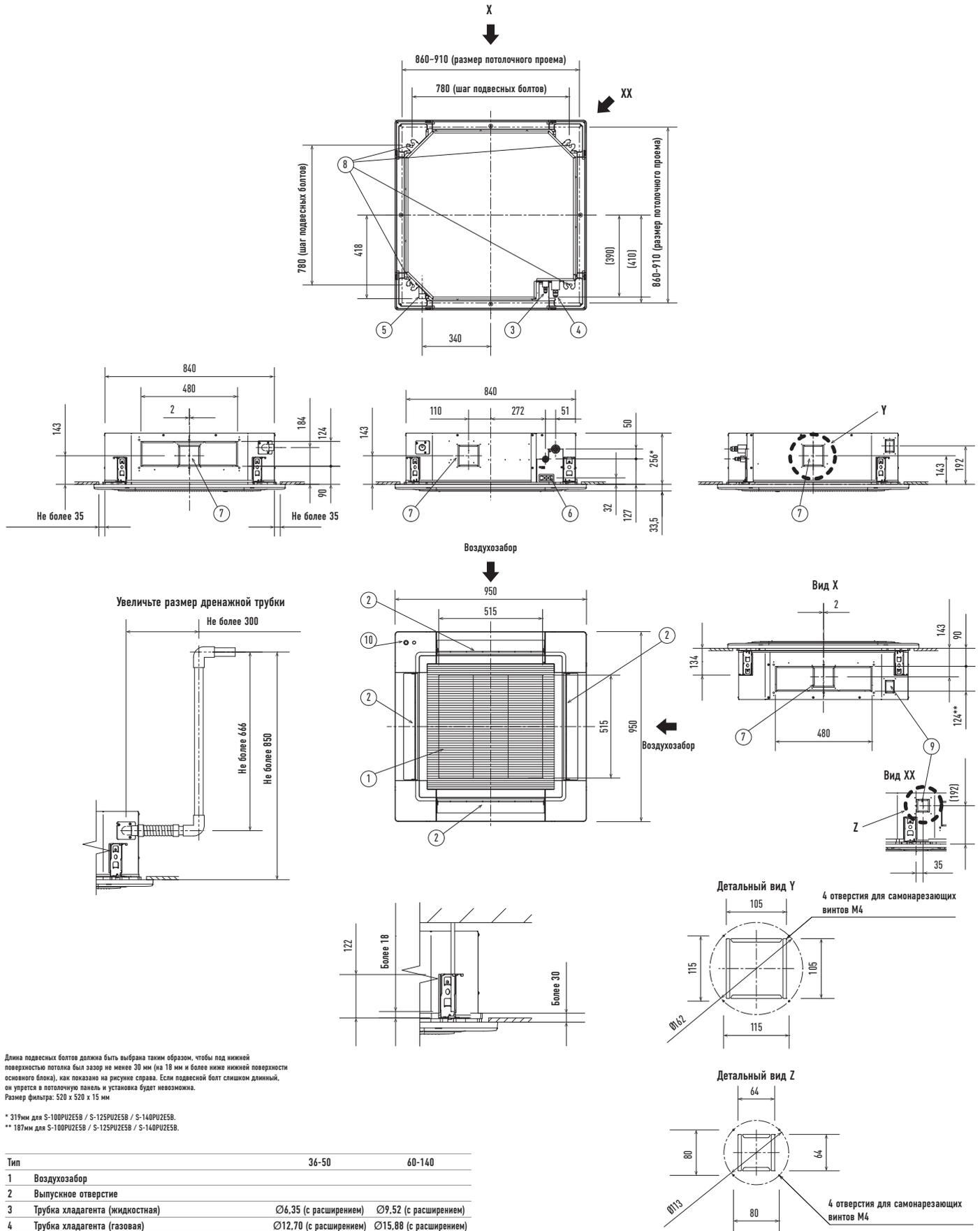
Длина подвесных болтов должна быть выбрана таким образом, чтобы под нижней поверхностью потолка был зазор не менее 30 мм (на 18 мм и более ниже нижней поверхности основного блока), как показано на рисунке справа. Если подвесной болт слишком длинный, он упрется в потолочную панель и установка будет невозможна.
