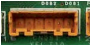
Внутренний блок ESOi легко подключается к внешнему устройству. Разъем T10, установленный на электронной плате всех внутренних блоков, позволяет осуществлять цифровое подключение к внешним устройствам.
