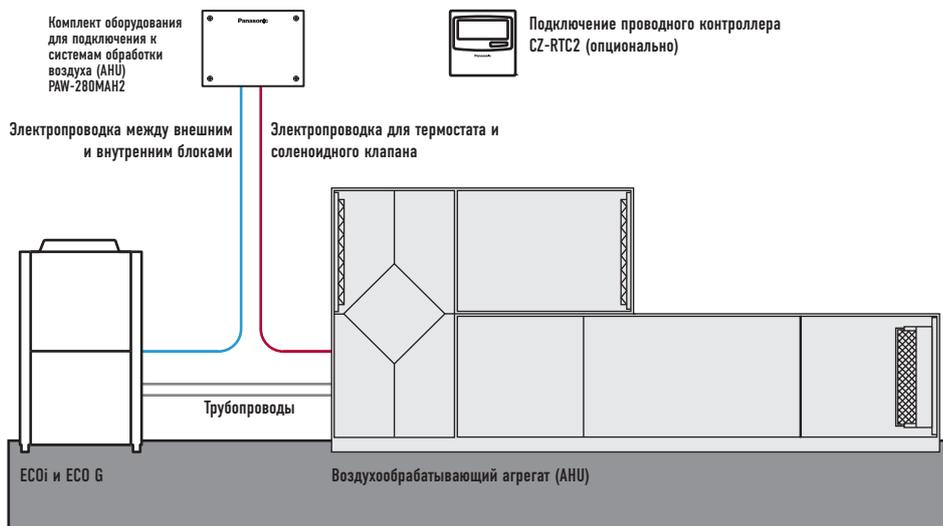
Пример системы высокой производительности (56 кВт)
