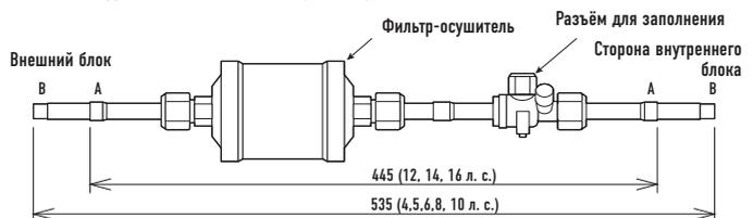
Размеры подключаемых трубопроводов (дюйм (мм)): А 1 / 2 (12.7) (12, 14, 16 л. с. ) - В 3 / 8 (9.52) (4, 5, 6, 8 и 10 л. с. )
