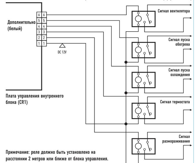
Примечание: реле должно быть установлено на расстоянии 2 метров или ближе от блока управления.
