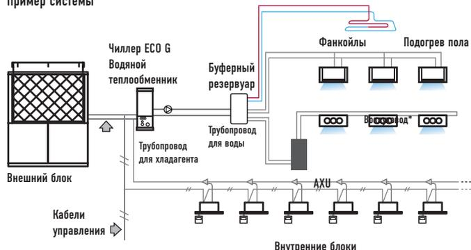
Примечание: Режим работы внешнего блока зависит от режима работы водяного теплообменника. Водяной насос не входит в состав блока водяного теплообменника. Однако, для одновременной работы максимальная мощность составляет 130%. Пожалуйста, задавайте вопросы относительно системных проектов Panasonic.
