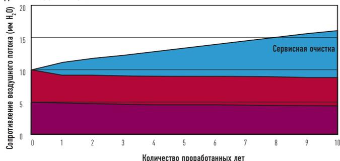
Старый элемент нуждается в периодической очистке. Элемент противоточного типа не нуждается в периодической очистке, потому что его сопротивление практически не повышается.
