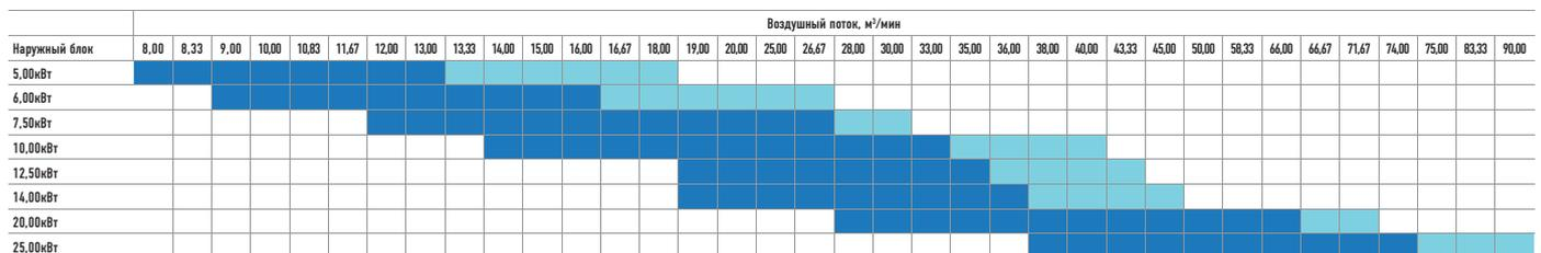
Стандартный диапазон расхода воздуха в стандартных условиях (температура воздуха на входе в режиме охлаждения от 18 до 32 °C).
