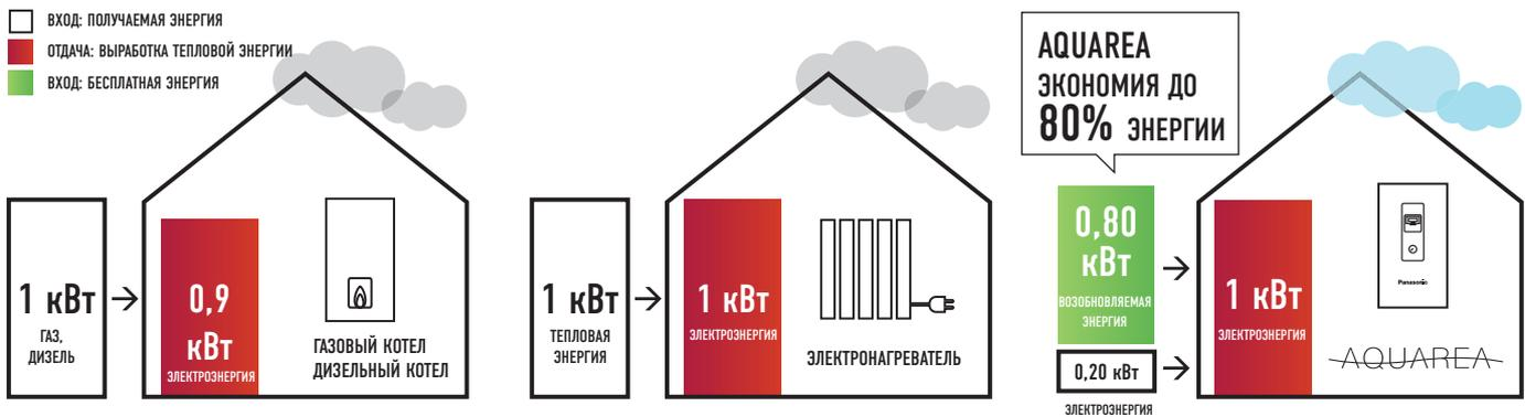
\*До 80% энергии, вырабатываемой тепловым насосом, оказывается бесплатной, поскольку энергоносителем является воздух, получаемый извне. Условия оценки: Отопление: Температура воздуха в помещении: 20°C на сухом термометре / Температура окружающей среды: 7°C на сухом термометре / 6°C на влажном. Условия: Температура воды на входе: 30°C. Температура воды на выходе: 35°C.
