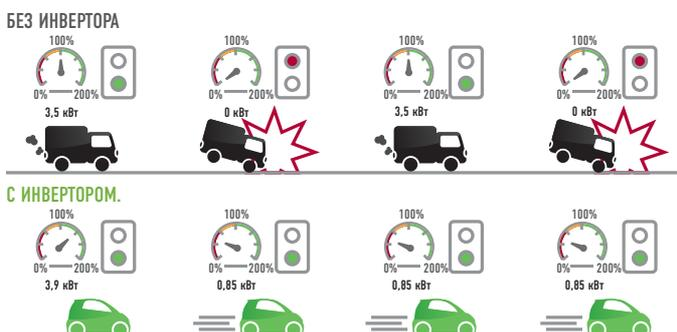
**БЕЗ ИНВЕРТОРА.** Длительный запуск. Больше времени требуется для достижения заданной температуры. Температура колеблется между двумя крайними значениями и никогда не стабилизируется. Температура быстро поднимается и опускается, возникают пиковые нагрузки.
