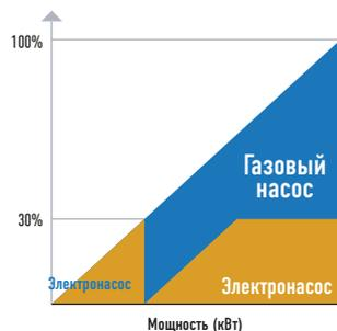
Режим с приоритетом газового привода
