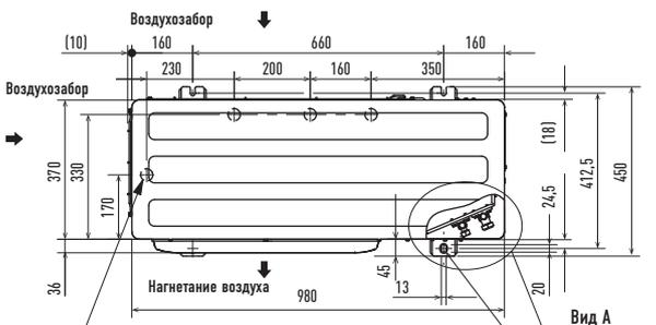
4 отверстия  $\varnothing 32$  (дренажные отверстия)
