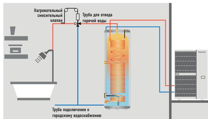
PRO-HT резервуар для отопления и охлаждения: PAW-VP380L. Водяное отопление и охлаждение для подогрева пола, радиаторов или вентиляторных доводчиков
