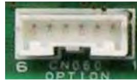
PAW-OCT: Panasonic разработал дополнительное оборудование, поставляемое по желанию заказчика, (состоящее из штекера и проводов) под названием PAW-OCT для простого подключения к разъему (CN060).
