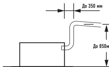
Дренажный насос позволяет поднять дренажную трубу на высоту около 850 мм от уровня потолка
