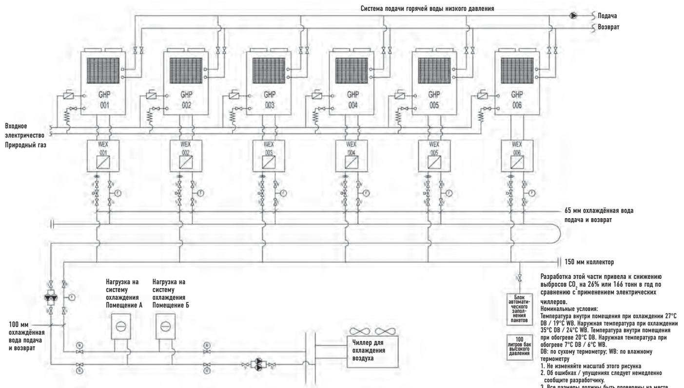
Газопроводная 2-трубная VRF-система с генератором электроэнергии ECO G High Power является революцией в разработке систем кондиционирования воздуха. Эта система оснащена генератором без несущих подшипников. Это первая VRF-система, которая может осуществлять нагрев, охлаждение, подачу горячей воды, а теперь ещё и вырабатывать электроэнергию. Каждый блок ECO G HIGH POWER оснащён генератором мощностью 2,0 кВт, что резко сокращает потребление электричества наружным блоком.
