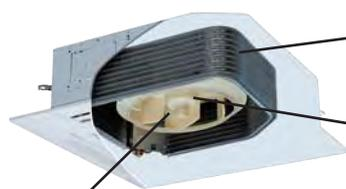
Высокоэффективный вентилятор с тихим турбо-режимом. Большой объём воздуха и низкий уровень звукового давления достигаются благодаря новой разработке корпуса вентилятора большего, чем в предыдущих блоках, размера и оптимизации конструкции пути воздушного потока.
