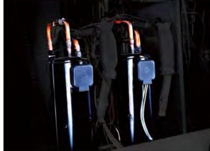
Включенные параллельно инверторные компрессоры большой производительности (более чем у предыдущей серии).
