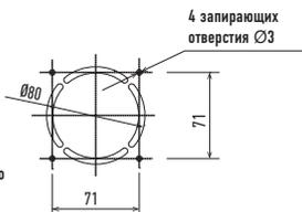
Размер соединительного порта воздуховода (приточного воздуха)
