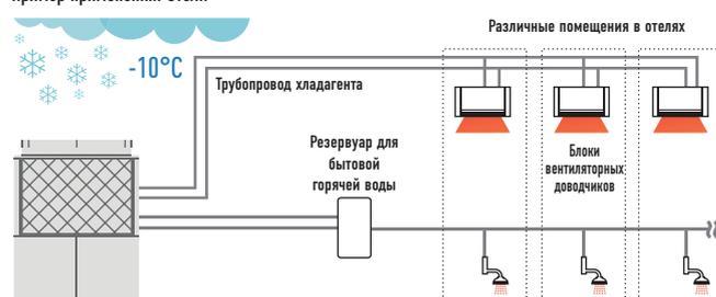
Отсутствие необходимости в дополнительных электрических нагревателях. \* Эта схема также действительна для теплообменников, утилизирующих тепло отходящих газов.
