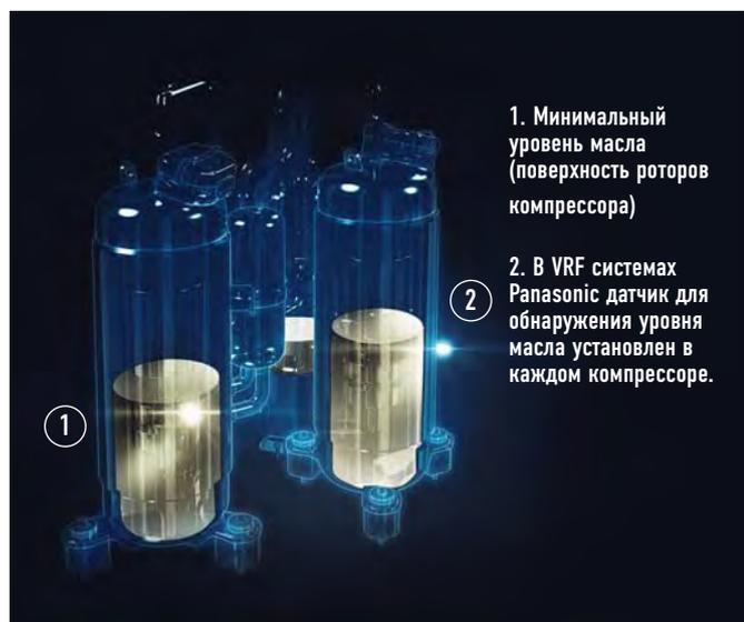
Система Panasonic позволяет эффективно управлять функцией возврата масла в три этапа: сведение к минимуму частоты принудительного возврата масла при одновременном снижении затрат на электроэнергию и улучшению комфорта.
