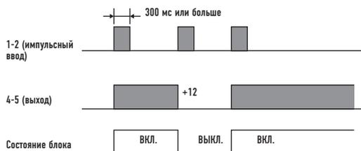
ПРИМЕЧАНИЕ: длина проводки от внутреннего блока до реле не должна превышать 2,0 м. Импульсный сигнал меняется на статический с помощью перемычки. (См. JPO01)
