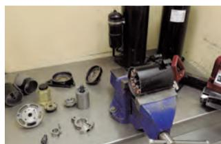
**Тест на надежность компрессора с последующим демонтажем и разборкой**
