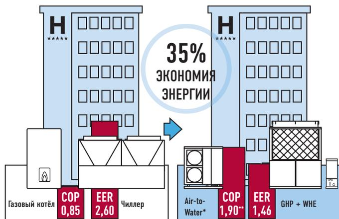
\* Электрическая система для того, чтобы покрыть пик потребления горячей воды. \*\* Коэффициент COP включает доставку горячей воды (U-20GE2EB). Расчет КПЭ и COP производился на первичных энергоисточниках.
