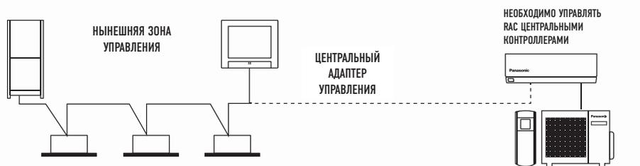
1.Нынешняя система для PACi / VRF. Центральный контроллер может подсоединяться к S-link линии для прямого управления элементами
